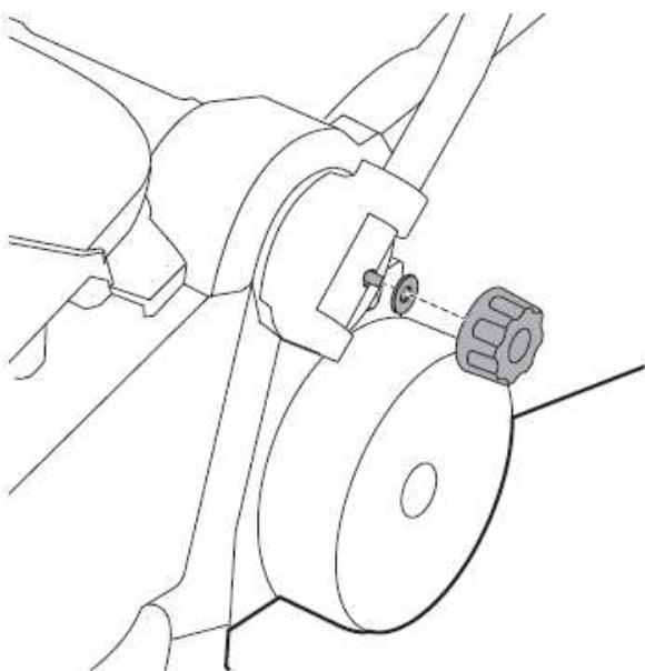
1. Установите нижние концы рукоятки в пазы на корпусе устройства.
