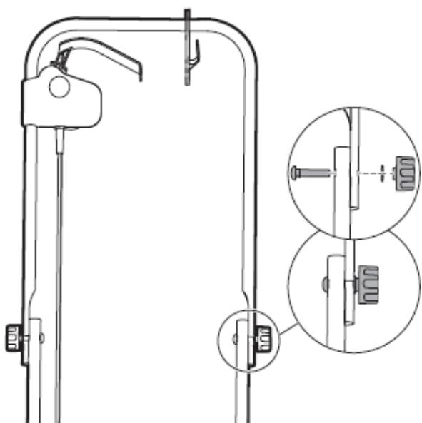
1. Соедините верхнюю и нижнюю части рукоятки с помощью болта, шайбы и барашковой гайки.
