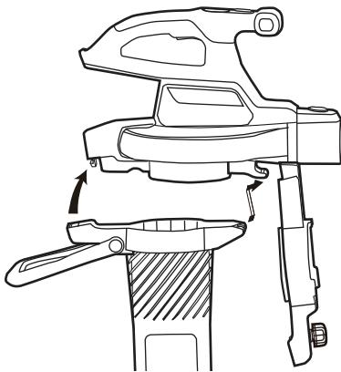
7. Для завершения установки трубы мульчирования потяните фиксирующую кнопку назад.
