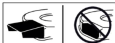
Изделие можно использовать только с установленным защитным козырьком или мульчирующей заглушкой.
