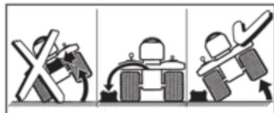
Перед переворачиванием устройства демонтировать аккумуляторную батарею.
